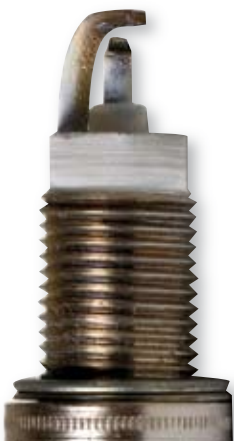
Die saubere Verbrennung im Motor einer XRGI Anlage ist direkt an den Zündkerzen sichtbar: Diese hier wurde nach 10.000 Bh ausgewechselt!
